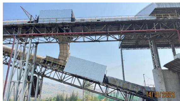
รูปที่ 3 ระบบสายพานลำเลียงกากอ้อยแบบปิด
