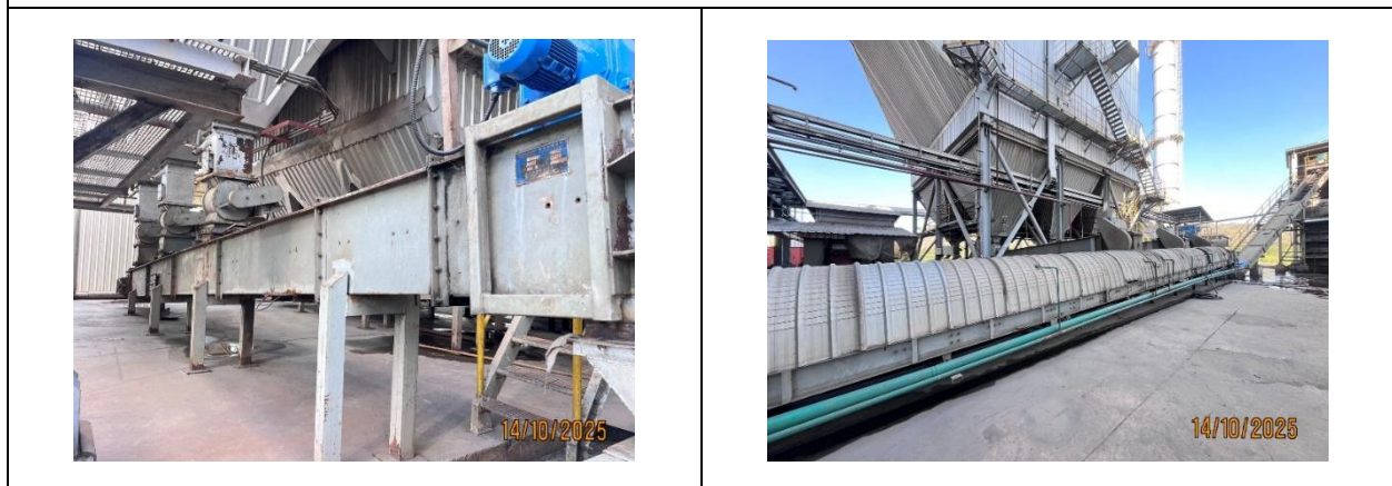
รูปที่ 14 ระบบดักตะกอนถั่ว
